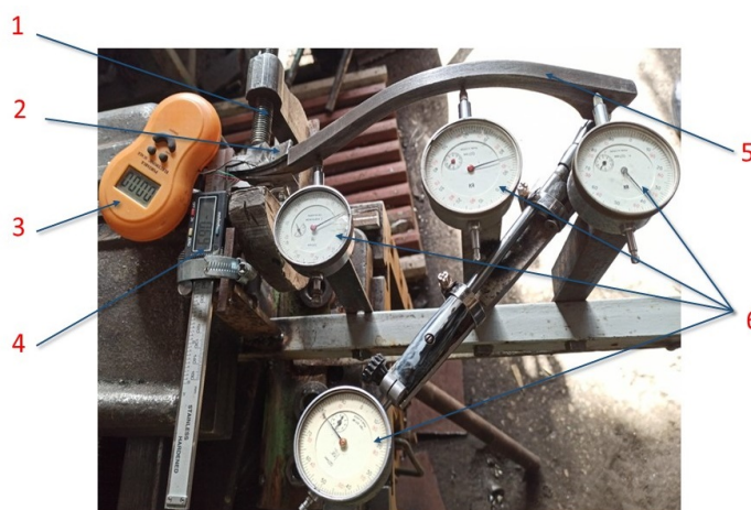
Рис. 4. Схема экспериментального устройства изгиба колосника при установке вставки: 1 – сила зажима; 2 – вставка; 3 – устройство измерения нагрузки; 4 – штангенциркуль; 5 – консоль колосник; 6 – индикаторы часового типа марки ИЧ-10 0.01
